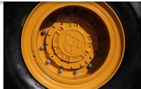
Продумана конструкція двуступінчастого редуктора зі сторони коліс
