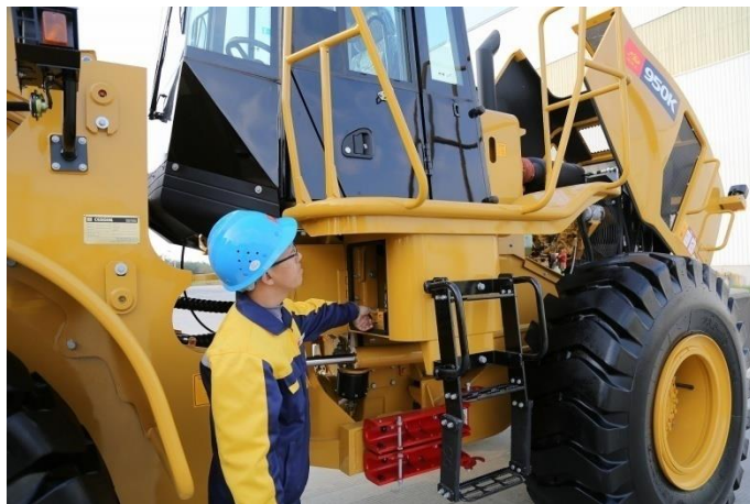
Механічний привод капоту для облякшення обслуговування двигуна
