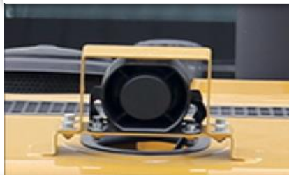
Автоматичний звуковий сигнал заднього ходу
